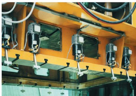
Utilización de elementos de sujeción oscilante electro-mecánicos en una prensa de doble montante.
