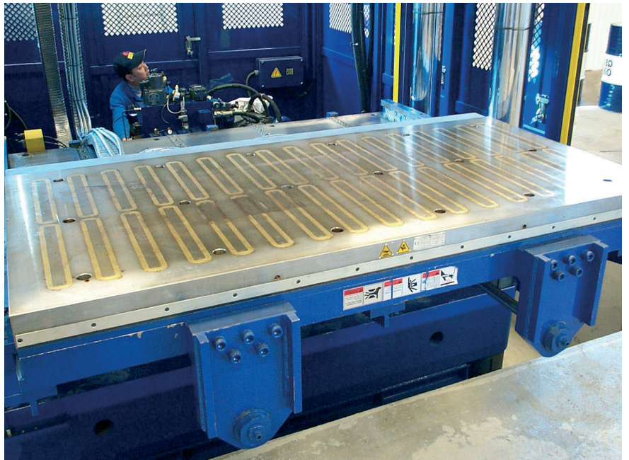
Magnet-Spannsystem auf einer Vertikalpresse für Einsatztemperaturen bis 240 °C
