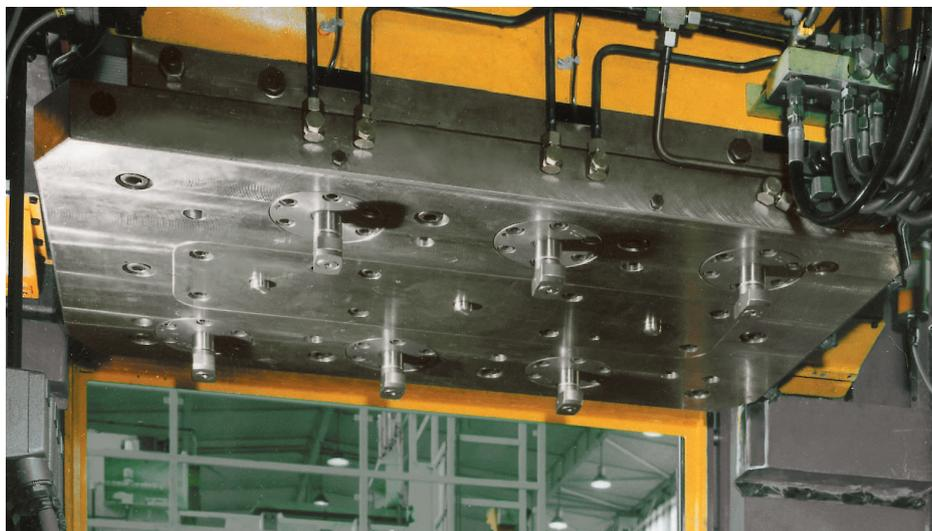
Utilisation d'éléments de serrage pivotants sur le coulisseau de la presse. Pour le changement d'outils, le coulisseau se trouve dans la position haute et les éléments de serrage pivotants sont sortis.
