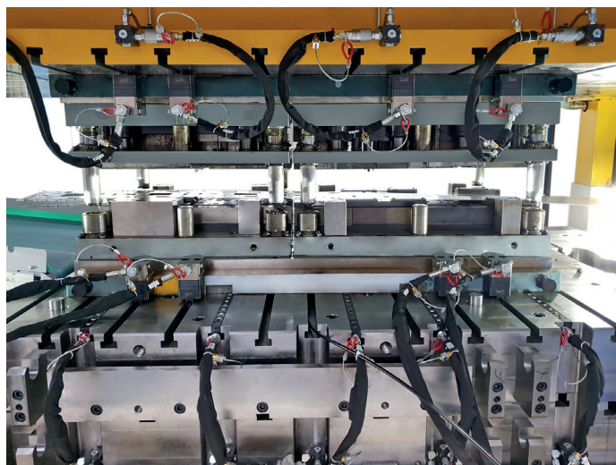
Têtes de serrage avec support en T sur la table et le coulisseau de presse
