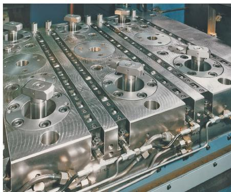
Utilización de elementos de sujeción giratorios escamoteables en una prensa de doble montante. El tirante de tracción se encuentra en la posición salida (posición de giro). El troquel o molde se posiciona mediante topes laterales. Fácil introducción de los moldes y troqueles gracias a reglas hidráulicas de rodillos en las ranuras en T.
