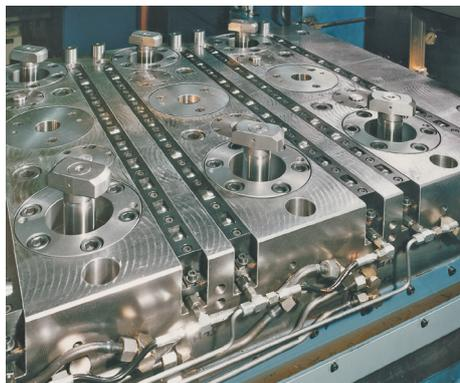
Utilisation des éléments de serrage pivotant escamotable sur une presse à deux montants.
