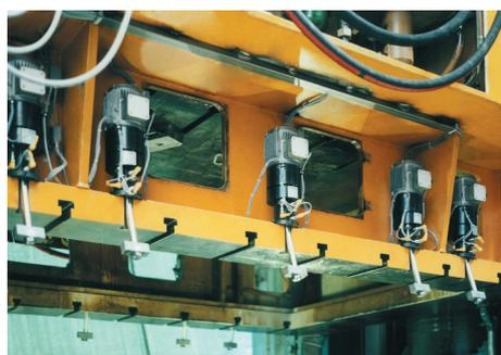
Impiego elementi di bloccaggio basculanti elettromeccanici in una pressa a doppio montante.
