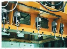
Impiego elementi di bloccaggio basculanti elettro-meccanici in una pressa a doppio montante.
