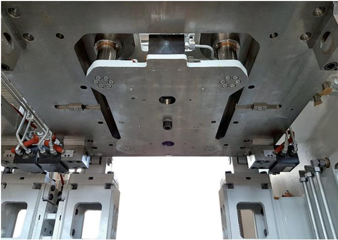
Elemento de sujeción en forma de cuña con conexiones hidráulicas **A+B** a la derecha y un circuito frigorífico adicional **C+D** en el lado opuesto a la izquierda
