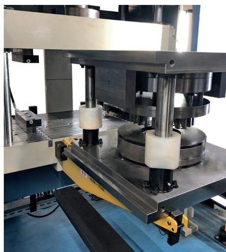
Tasseaux de serrage installés sur la table et le coulisseau de presse. Mouvement aisé des outils grâce aux consoles et aux tasseaux à billes hydrauliques dans les rainures en T de la table de presse.
