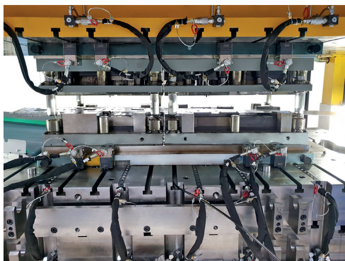
Morsetto di bloccaggio con adattatore per cava a T nella tavola della pressa e slittone
