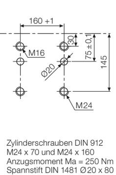
Zylinderschrauben DIN 912
