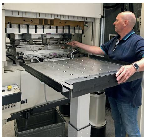
Anwendung Werkzeug-Wechselwagen RW 500 mit Kugeltisch an einer Bruderer Stanzmaschine
