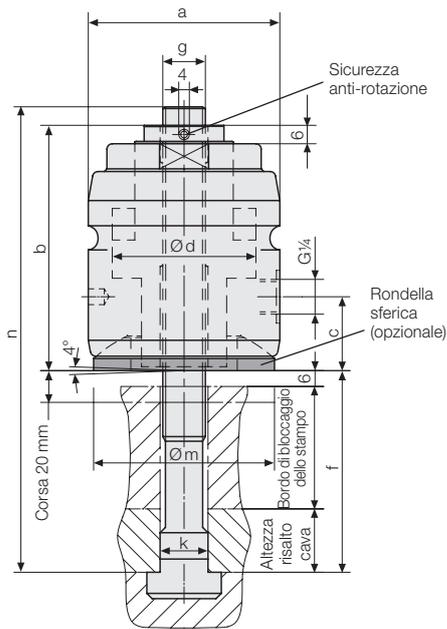
Adattamento ottimale a differenti altezze del bordo di bloccaggio degli stampi grazie ad una corsa totale più elevata pari a 20 mm (corsa totale ancora maggiore a richiesta).
