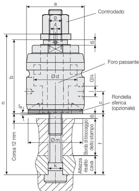
Adattamento regolabile liberamente e in modo flessibile a differenti altezze del bordo di bloccaggio degli stampi con uno spostamento rapido e semplice del tirante tramite controdado. Il tirante in questa versione viene inserito attraverso il cilindro a pistone cavo e viene fissato, grazie al controdado, alla quota di registrazione corretta.
