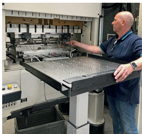
Zastosowanie: wózek do wymiany form RW 500 z stołem kulkowym na prasie wykrawającej Bruderer.
