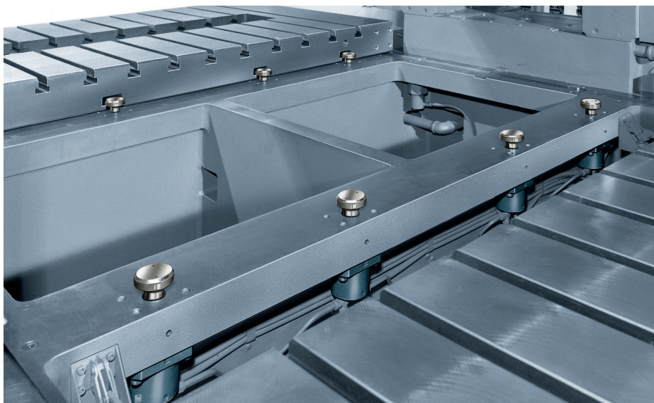
Spannen eines Wechseltischs mit Zugspannelementen
