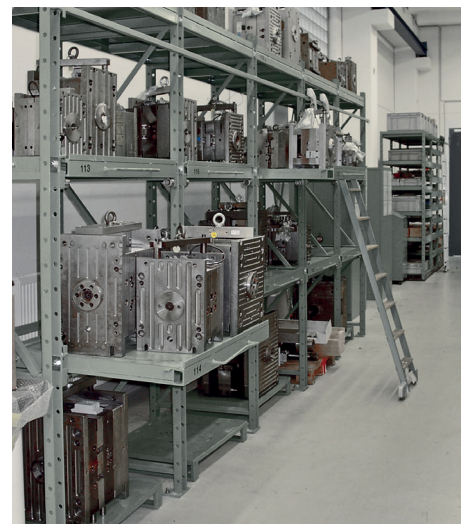
Magazzino stampi con estensione totale
