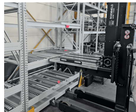
Carrello per cambio stampi RWA 4000 con barra di aggancio e catena di trazione-spinta
