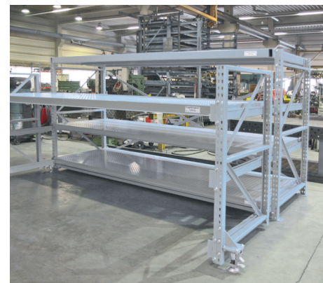
Rayonnage d'outils avec guides latéraux escamotables
