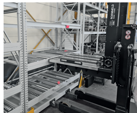
Chariot pour changement d'outils RWA 4000 avec tasseau d'accostage et chaîne de traction-poussée
