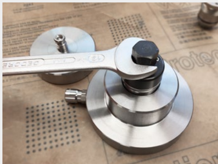
Visser à l'aide d'une clé de montage (15 Nm)
