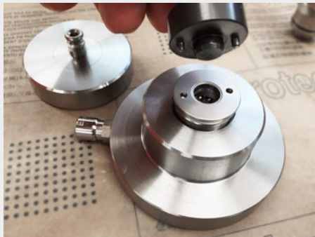
Insérer STARK.basic.Y dans le trou de montage
