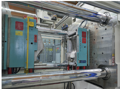
R-MAG-P, mit Quadratpolen für Spritzgießmaschinen bis 300 t
