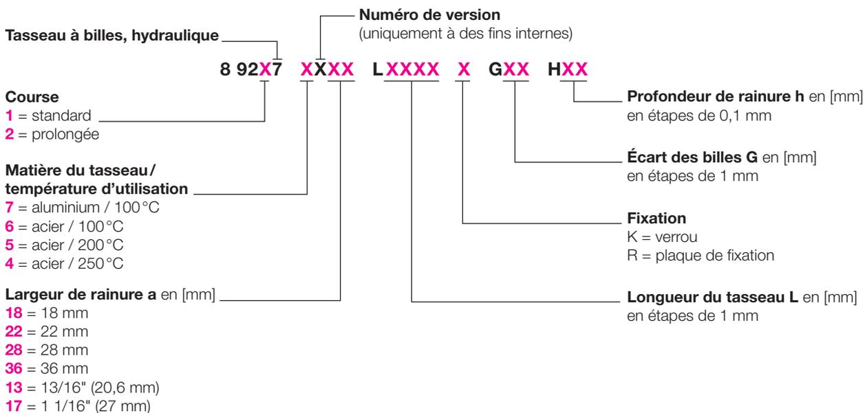
La page 4 montre l'exemple des références pour les tasseaux en aluminium avec l'écart des billes standard « G » et profondeur de rainure standard « h ».
