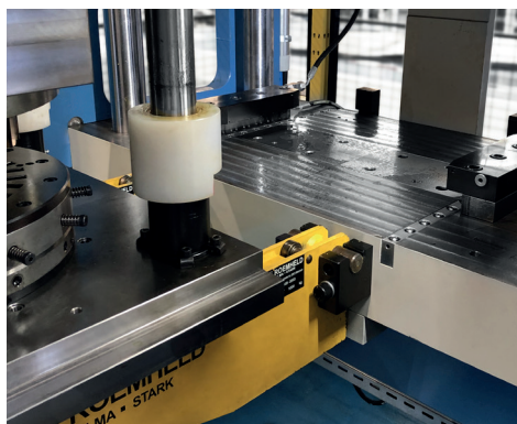
Tasseaux de serrage installés sur la table et le coulisseau de presse. Mouvement aisé des outils grâce aux consoles et aux tasseaux à billes hydrauliques dans les rainures en T de la table de presse.
