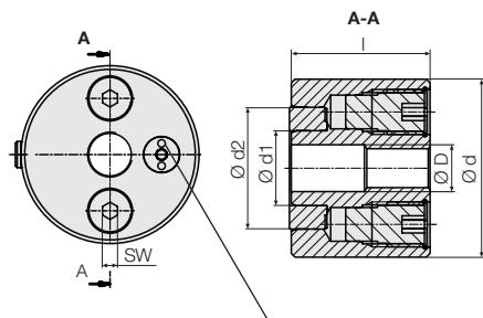
Sporgenza del perno indicatore ottico della forza di serraggio al raggiungimento della forza di serraggio nominale:
