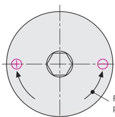
Freccia di direzione per bloccaggio e sbloccaggio
