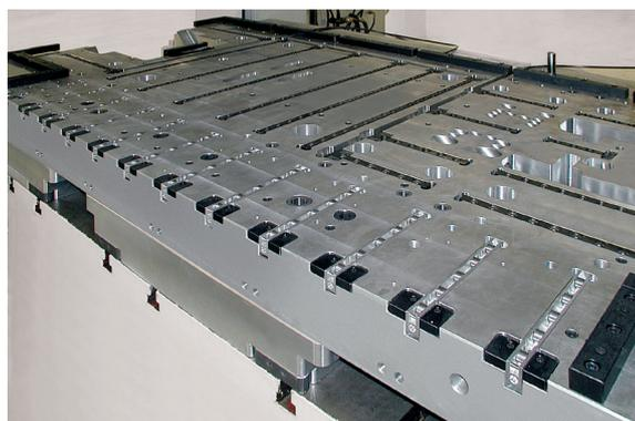
Reglas de rodillos con elevación hidráulica
