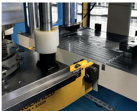
Reglas de sujeción montados en la mesa inferior y la mesa superior de la prensa. Fácil introducción de los moldes y troqueles gracias a consolas portadoras y reglas hidráulicas de bolas en las ranuras en T de la mesa inferior de la prensa.
