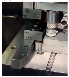
Montaje posterior en una prensa de doble montante Ayuda de introducción mediante regla intermedia achaflanada y reglas de bolas
