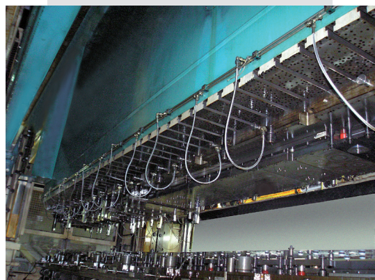
Spannelemente an einer Transfer-Großpresse der Fa. Schuler.
