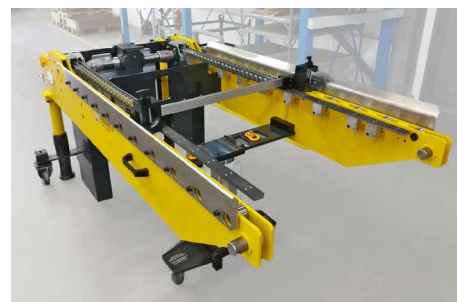
Sicht auf Zug-Schubkette und Werkzeugadapter
