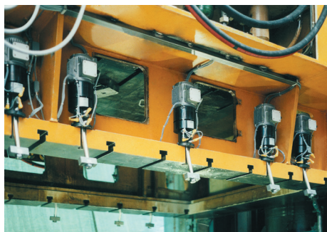
Einsatz von elektromechanischen Schwingklammern an einer Doppelständerpresse
