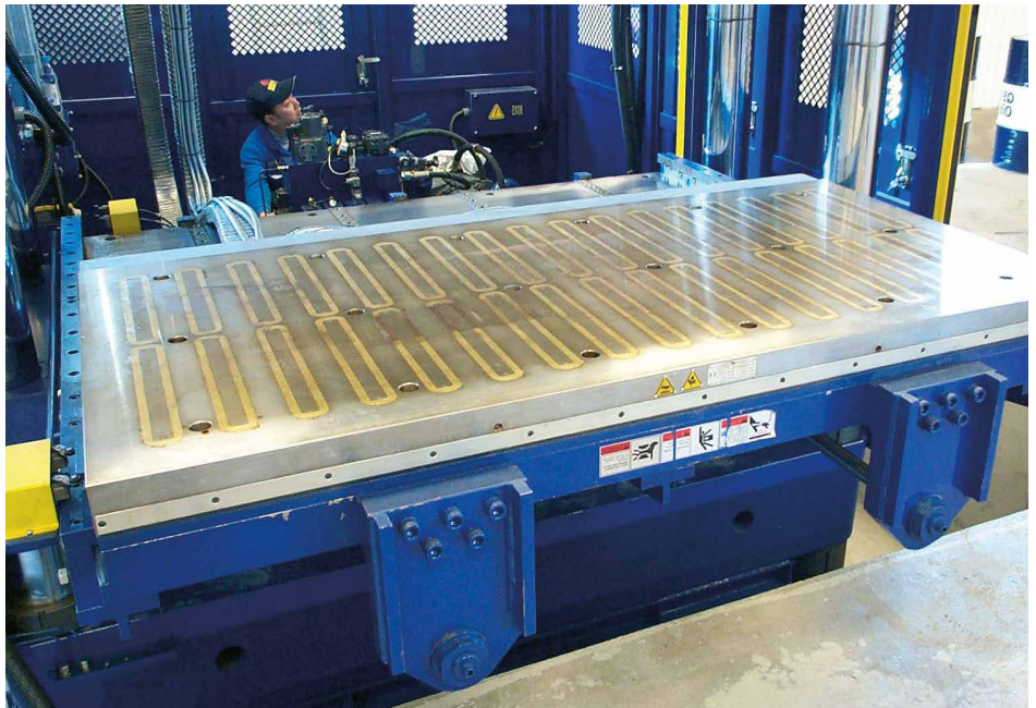
Magnet-Spannsystem auf einer Vertikalpresse für Einsatztemperaturen bis 240 °C
