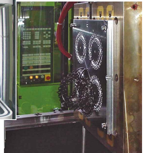
M-TECS R Magnet-Heizplatte auf einer Elastomermaschine – vollflächige Magnetkraft bringt vollflächigen Kontakt und verbesserte Temperaturhomogenität
