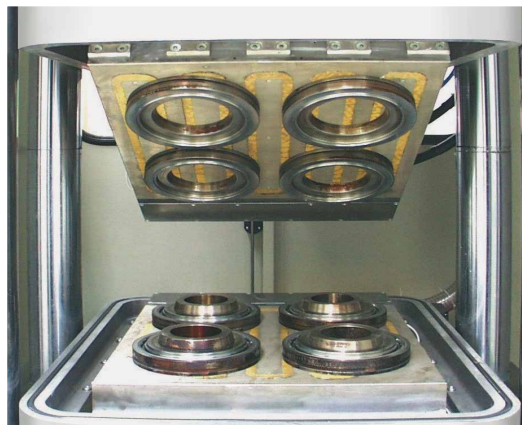
M-TECS R auf einer Vertikalpresse – Mehrfachformen auf einem Tisch ohne Platzverlust durch Spannpratzen
