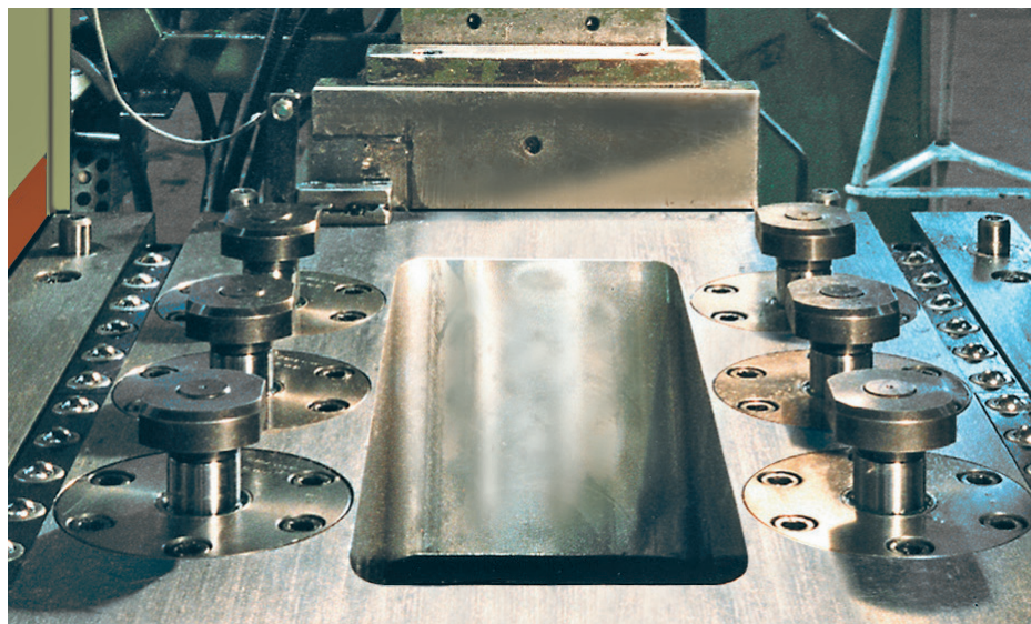
Éléments de serrage à traction dans la table d'une presse à deux montants.
