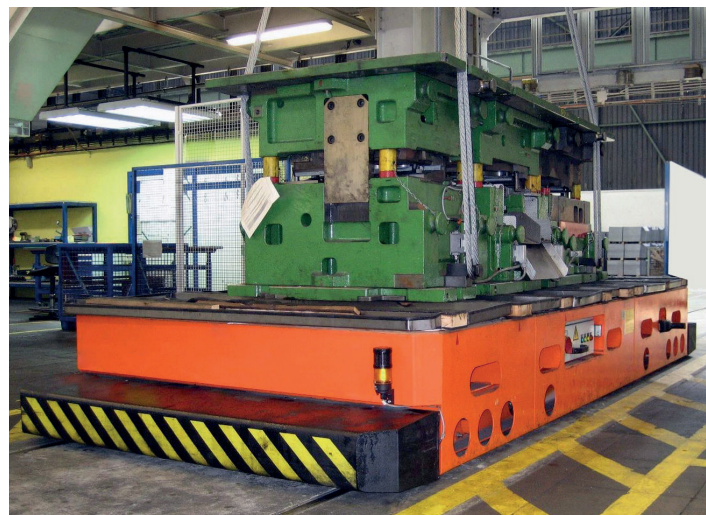
Chariot de transport, déplaçable sur rails ronds
