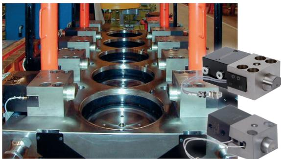
Stazione di stampaggio a 5 stadi, dotata di elementi di bloccaggio a cuneo (con valvole a sede di tenuta per il comando dei singoli stadi).
