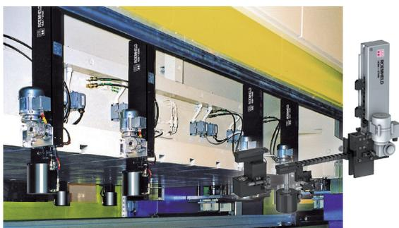
Sistemi di bloccaggio rapido con catena di traslazione sullo slittone di una pressa a due montanti.
