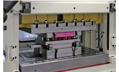
Sistema di bloccaggio magnetico
