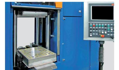
Sistemi di bloccaggio magnetico
