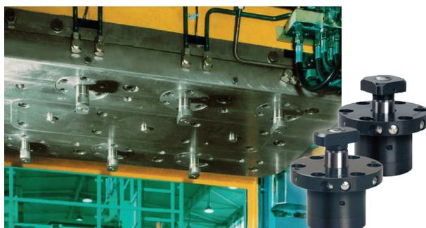
Staffe rotanti nello slittone di una pressa. Posizione per cambio stampo: slittone in alto, staffe rotanti in posizione estesa.
