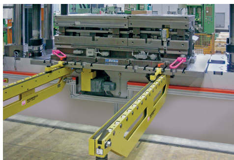
Sistema de cambio de troqueles adaptado a la prensa
