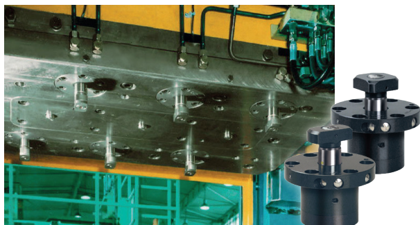
Elemento de sujeción giratorio en la mesa superior de la prensa. Posición para el cambio del troquel; mesa superior en posición alta, elemento de sujeción giratorio avanzado
