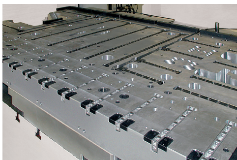
Reglas de rodillos con elevación hidráulica integradas en una mesa inferior de la prensa.
