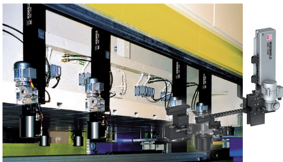
Sistema de sujeción rápida con cadena de empuje en la mesa superior de una prensa de doble montante
