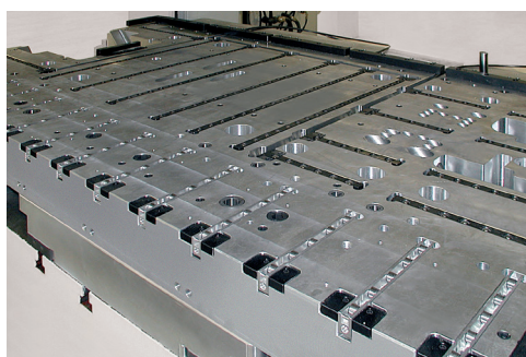
Görgőslécek hidraulikus kiemeléssel présasztalba integrálva
