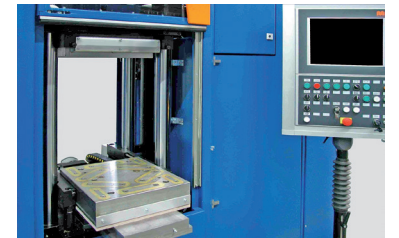
M-TECS R mágneses rögzítő rendszerek gumi- és műanyag ipar számára 240 °C-ig
