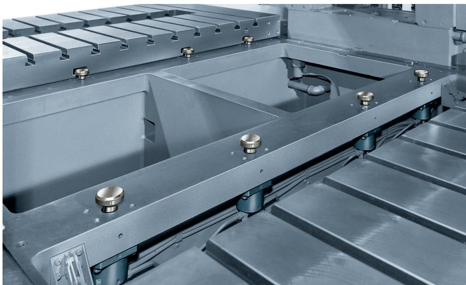
Bloccaggio di una tavola intercambiabile con elementi di bloccaggio a trazione
