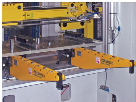
Eingehängte, verschiebbare Tragkonsolen
