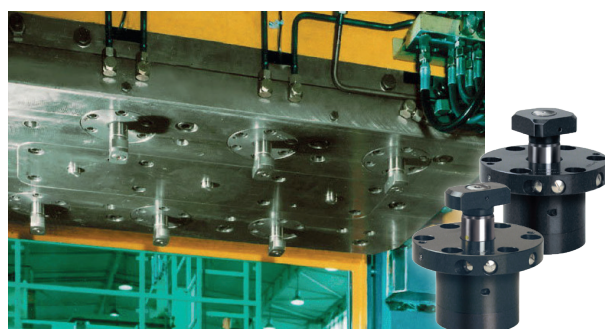
Dociski mocujące skrętne w suwaku prasy. Pozycja zmiany narzędzia; suwak prasy w górnym położeniu, docisk mocujący wysunięty.
