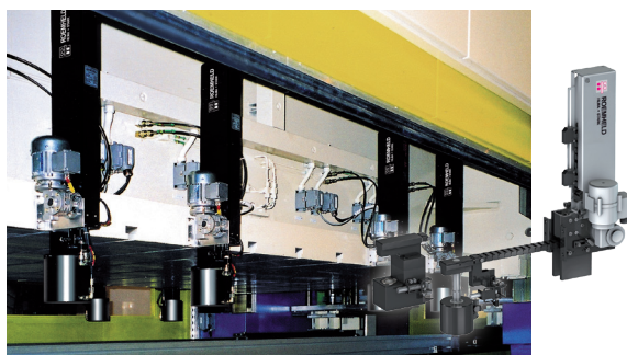
Elektryczny system szybkiego mocowania narzędzi z dosuwem łańcuchowym na suwaku prasy bramowej.
