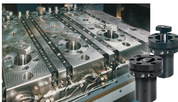
Dociski skrętno-ciągące zabudowane w stole prasy bramowej (końcówka mocującą T do docisku wysuniętą w pozycji mocującej).
