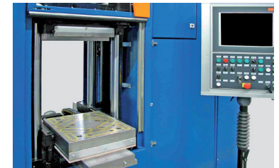
System mocowania magnetycznego M-TECS 240 dla przetwórstwa gumy i duropłastów. Temperatury do 240 °C
