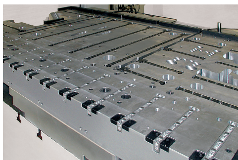
Listwy rolkowe podniesione hydraulicznie zabudowane w stole prasy.
