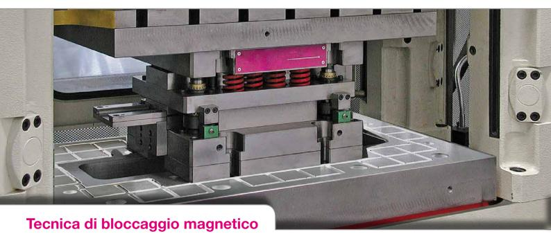
R-MAG piastre e i sistemi di bloccaggio magnetici per macchine di stampaggio a iniezione, presse di formatura, presse per gomma e portastampi o macchine per pressofusione
