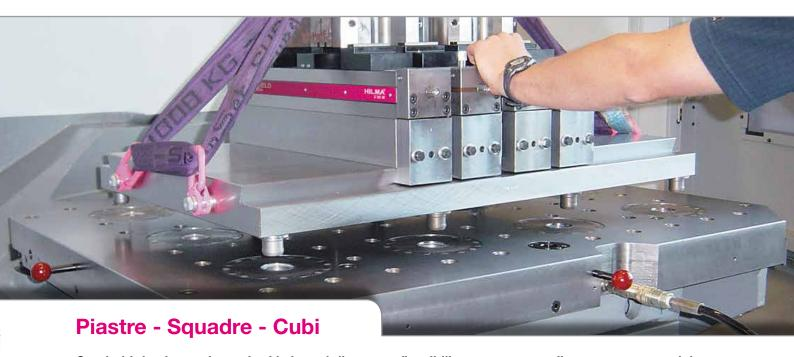
Costituiti da elementi standard i sistemi diventano flessibili, con un tempo di messa a punto minimo – meccanici – idraulici – pneumatici – elettrici – a semplice effetto – a doppio effetto –
