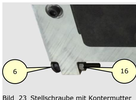
Bild 23 Stellschraube mit Kontermutter
