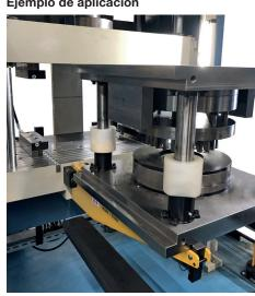
Reglas de sujeción montados en la mesa inferior y la mesa superior de la prensa. Fácil introducción de los moldes y troqueles gracias a consolas portadoras y reglas hidráulicas de bolas en las ranuras en T de la mesa inferior de la prensa.
