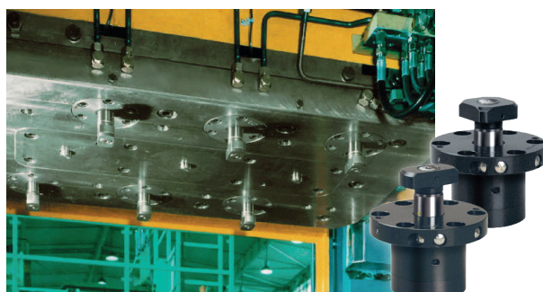
Éléments de serrage pivotants installés sur le coulisseau. Position pour le changement d'outils; le coulisseau dans la position haute, éléments de serrage pivotants sortis
