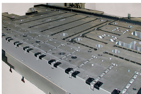
Tasseaux à rouleaux à soulèvement hydraulique intégrés dans une table de presse
