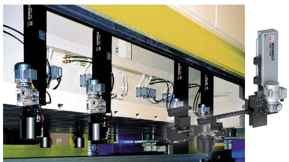
Systèmes de serrage rapide avec chaîne de poussée sur le coulisseau d'une presse à deux montants
