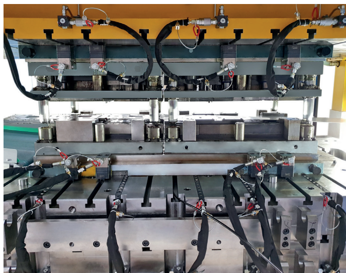
Morsetto scorrevole con adattatore per cava a T nella tavola della pressa e nello slittone
