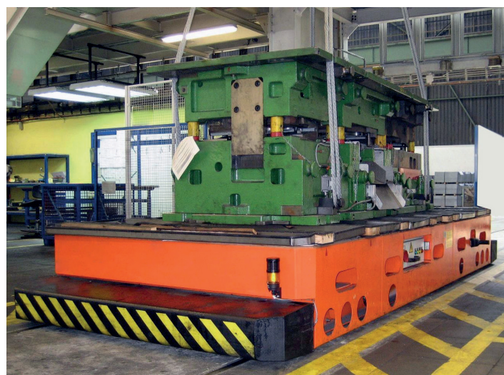
Carro de transporte, desplazable sobre raíles redondos
