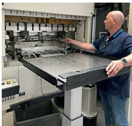
Aplicación del carro para el cambio de troqueles y moldes RW500 con mesa de bolas en una troqueladora Bruderer
