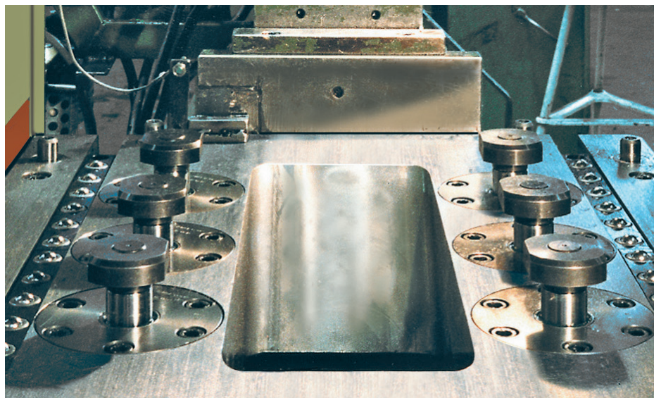
Elementos de sujeción a tracción en la mesa inferior de una prensa de dos montantes
