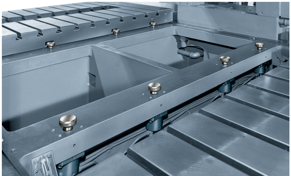
Bloqueo de una mesa de cambio mediante elementos de sujeción a tracción
