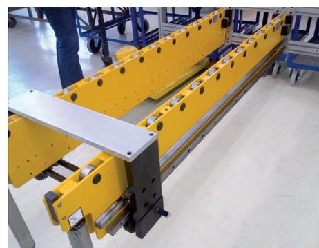
Werkzeug-Wechselkonsole mit Handkurbel
