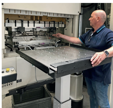
Applicazione del carrello di cambio stampi RW 500 con tavola a sfere su una pressa per tranciatura Bruderer
