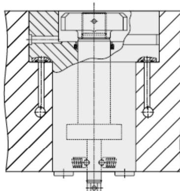
En este tipo de conexión la alimentación del aceite se realiza a través de orificios taladrados en la mesa inferior o en la superior. No hay tubos ni racores exteriores. La obturación estanca se logra mediante las juntas tóricas que se adjuntan al suministro.
