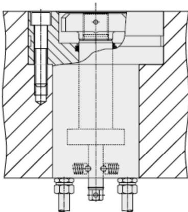
La conexión con tubería está indicada cuando los orificios roscados son fácilmente accesibles y con ello no se dificulta el montaje y desmontaje de los elementos de sujeción giratorios es-camoteables.
