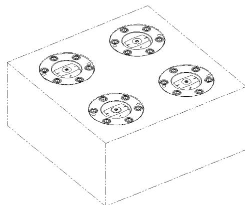
4. Conectar la central hidráulica. Con el mando "desbloquear", el tirante de sujeción se desplaza en la posición de desbloqueo.
