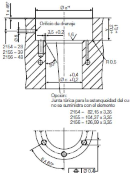
En caso de conexión adosada es indispensable una ejecución perfecta de la superficie plana. El orificio de drenaje se puede encontrar en cualquier punto, siempre y cuando los líquidos para desmoldear y para pulverizar puedan evacuarse libremente.
